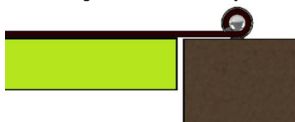
Gond pour volet simple : Axe du gond à 14mm de la façade
