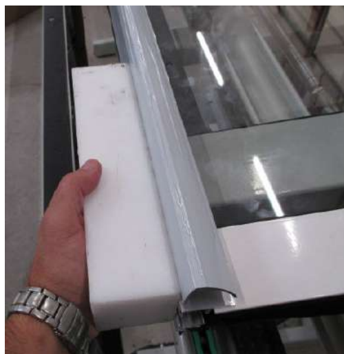
Collage de la jonction du joint périphérique située en partie haute et centrale
