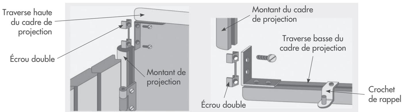
Principe d'assemblage du cadre de projection
