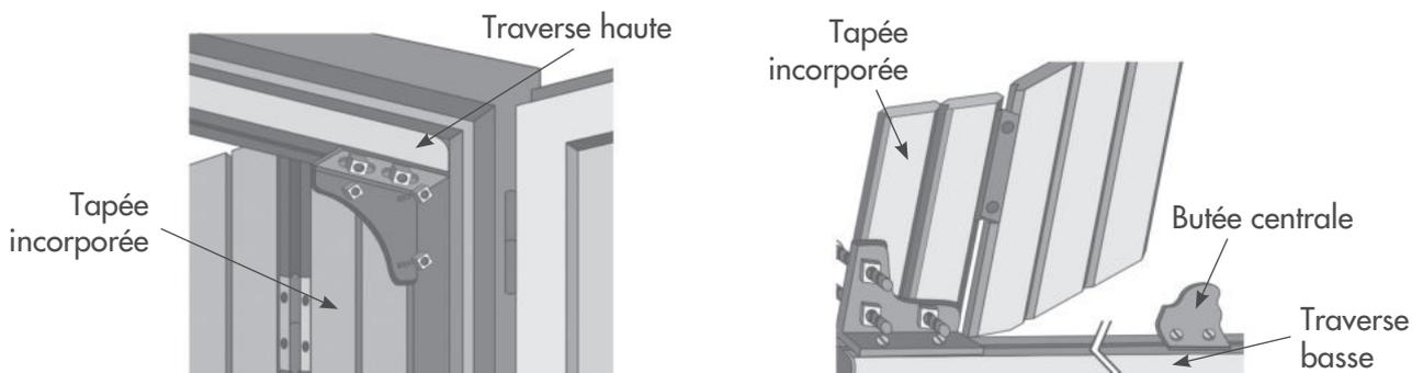
Principe d'assemblage de la tapée incorporée sur le cadre de projection
